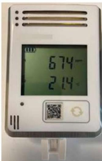
Figura 5. Instrumentos de medida de CO<sub>2</sub> ambiente empleados para verificar la calidad del aire.
